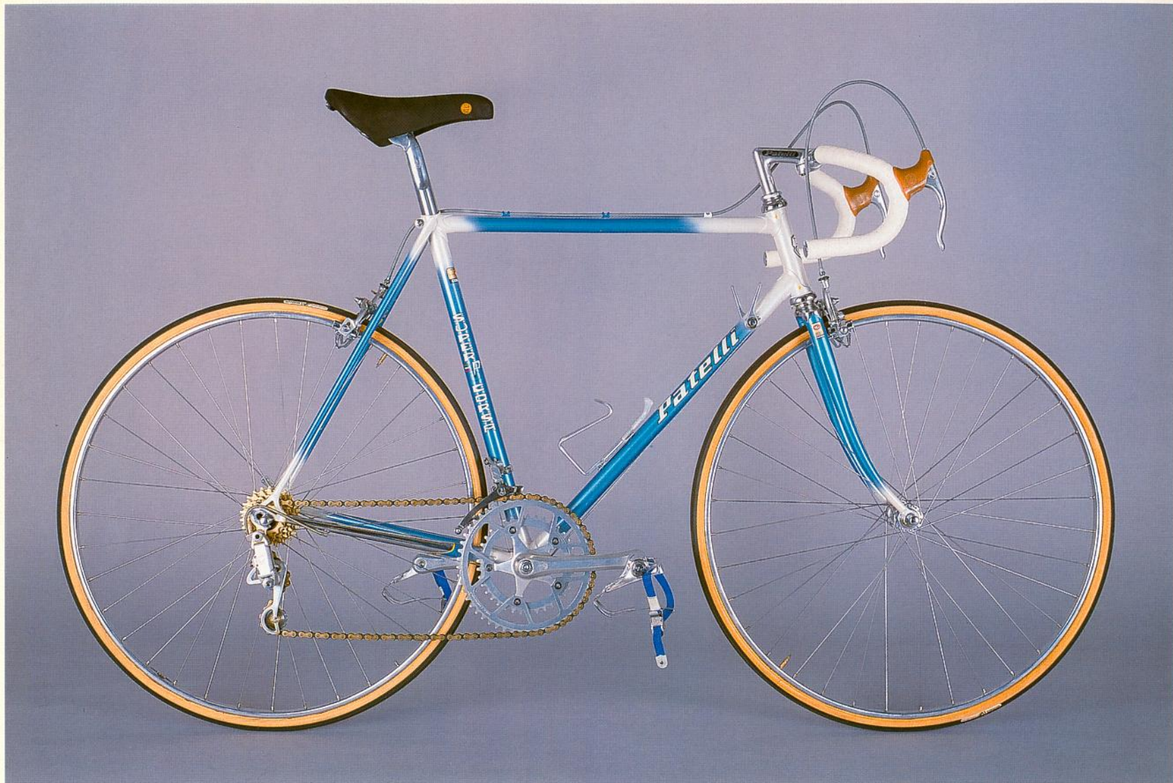
MODELLO TRIOMPHE Telaio 3 Tubi Columbus - Catnea e Ruota libera Regina Oro - Tubolari Clement Condor - Raggi ACI - Manubrio 3ttt - Pompa Silca - Sella «S. Marco Italia»
