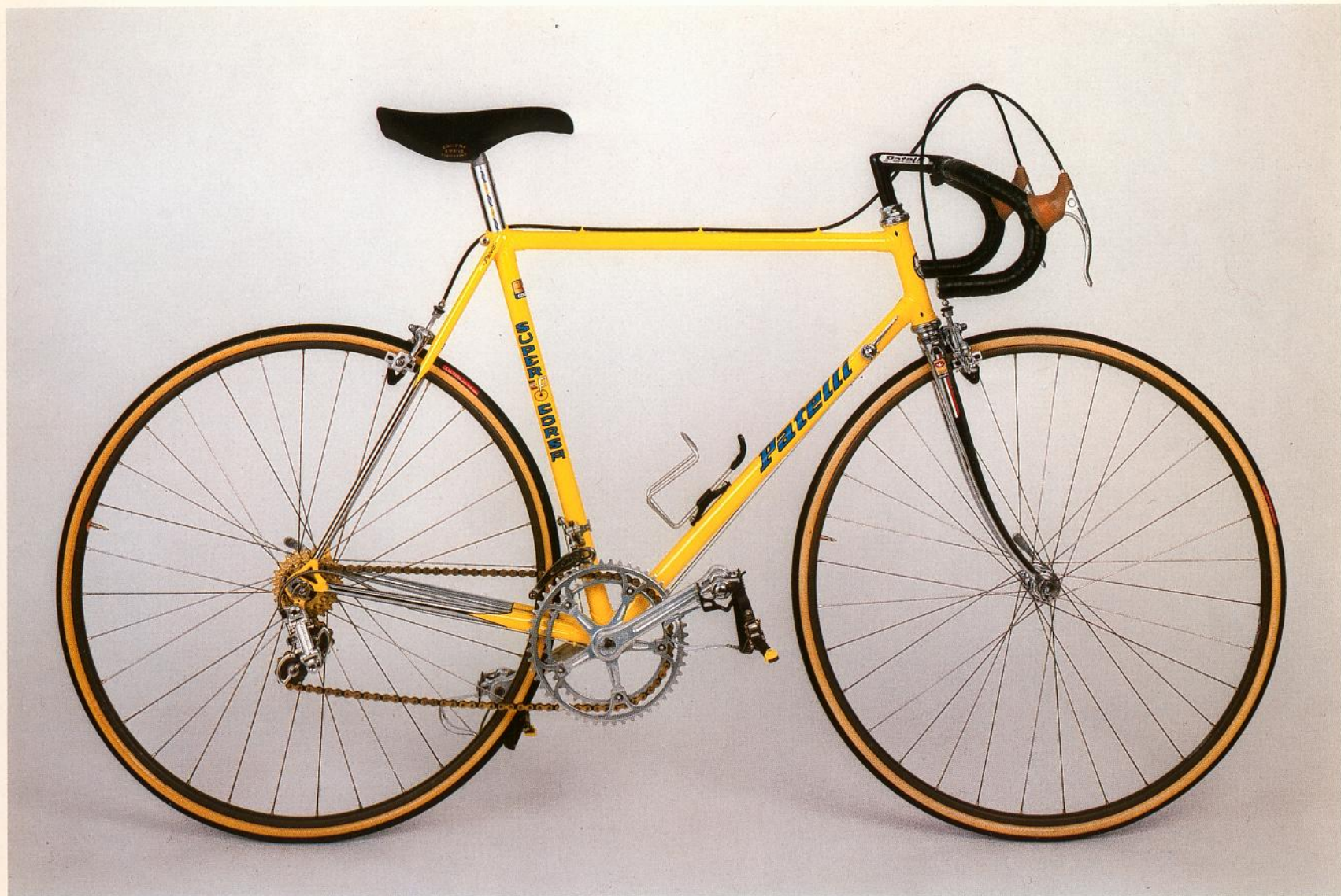
CICLO SUPER CORSA NUOVO RECORD Telaio Columbus SL - Gruppo completo Campagnolo 1032/F - Ruota libera Regina Oro - Catena Regina Oro - Sella Concor - Manubrio 3ttt - Cerchi Nisi stretto - Raggi Aci - Tubolari Clement Criterium
