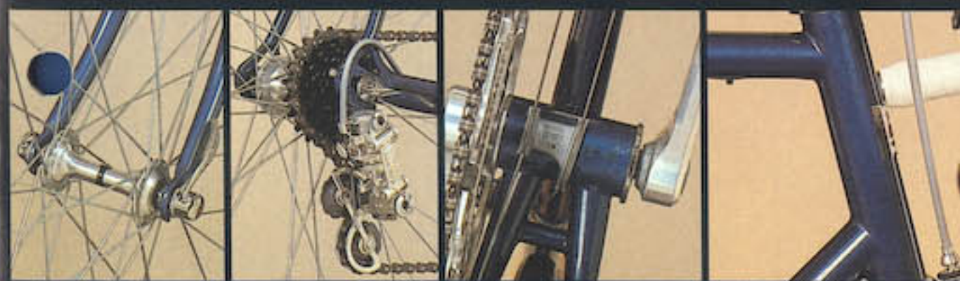
1 - CAMPAGNOLO RECORD HUB. - 2 - CAMPAGNOLO RECORD DERAILLEUR. - 3 - DERAILLEUR CABLE GUIDES. - 4 - COLUMBUS SL LUGLESS BRAZING.
