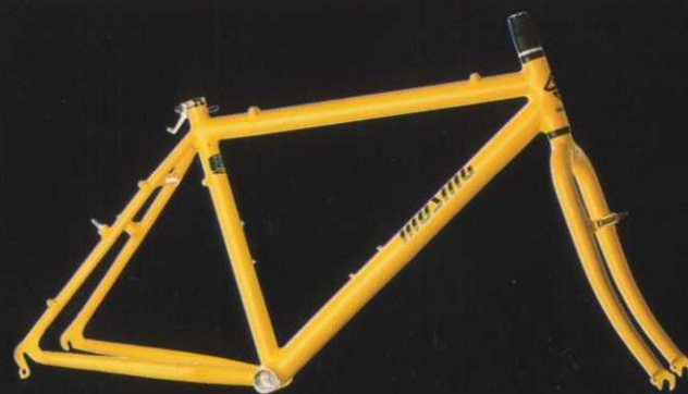
Mirar (Race-MTB-Frame) Rahmen: Aluminium-Legierung 7020 Gabel: Aluminium Gewicht: Rahmen: 1780 gr., Gabel: 800 gr. Farbe: Gelb oder Granit
