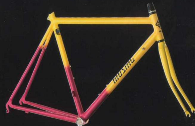
Izalco (Race-Frame) Rahmen: Aluminium-Legierung 7020 Gabel: Aluminium geklebt (Bei 66 cm mit Cro.-Mo. Unicrown-Gabel) Gewicht: Rahmen: 1550 gr., Gabel: 570 gr. Farbe: Gelb-Pink oder Brillant Schwarz
