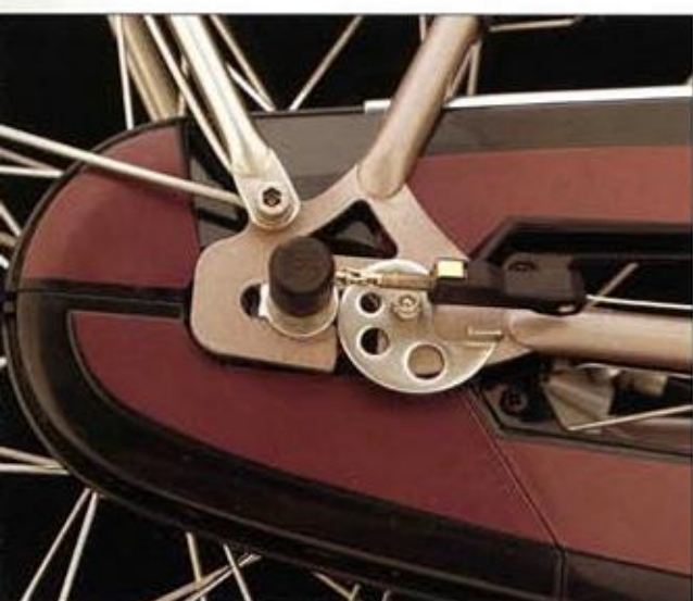
Koga-Miyata's achtereervoorconstructie voor snelle montage en demontage van achterwiel en ketting spannen (RA/RAL).
