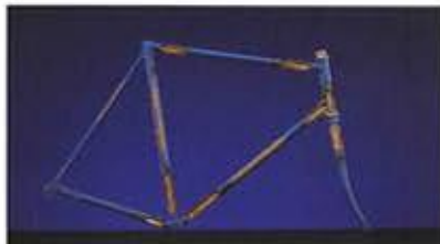
Opengewerkt "bonded" aluminium frame. Let op de speciaal in de lugs aangebrachte gepatenteerde versterkingen.
