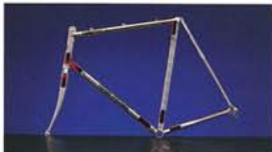
Opengewerkt "bonded" aluminium frame. Let op de speciaal in de lugs aangebrachte gepatenteerde versterkingen.
