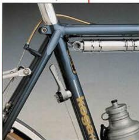
Speciale hevel om tijdens het rijden de dynamo in en uit te schakelen.
