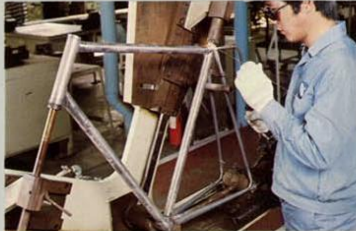
Door de beste specialisten van Miyata in Japan worden de frame's gesoldeerd. Ook dit gebeurt volgens de zogenaamde "koude" methode. Dit om de materiaalstructuur te handhaven, wat een grote sterkte van de verbindingen garandeert.
